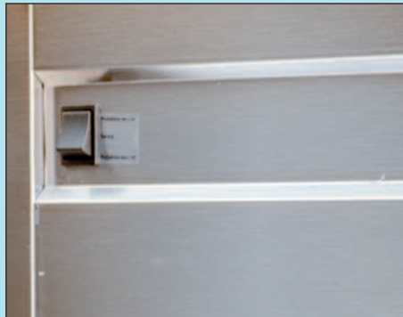
Frontblende mit eingearbeiteter Vertiefung und integriertem Produktionsschalter
